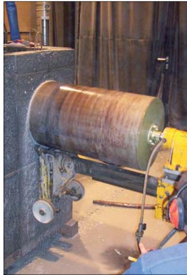
Abb. Prüfmethode mit Schneidbrenner (oben) und Diamantkronenbohrer (rechts)
